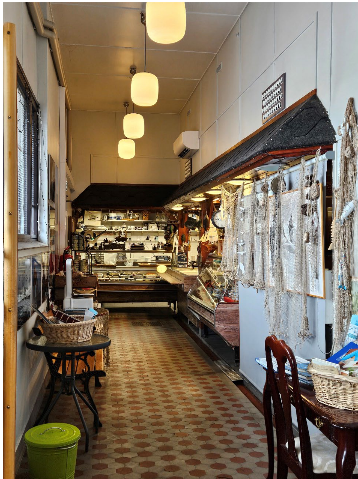
Kuva 96. Kalanmyynti hallikäytävän eteläpäässä. Valaisimet ovat alkuperäiset, samoin levytetyt, maalatut seinä- ja kattopinnot sekä klinkkerilattia.
