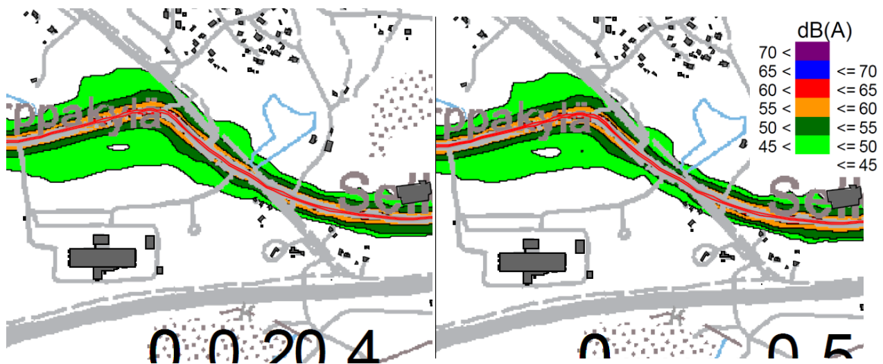
Kuva 24 Alueen melutilanne päiväaikaan vasemmalla nykytilanteessa ja oikealla ennuste vuodelle 2035. (Lappeenrannan meluselvitys ja meluntorjuntaohjelma, Ramboll Finland, raportti 18.3.2015.)
