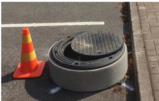
Kuva 2. Mittauspiste MP4. Anturi suojaus renkaalla ja kannella.
