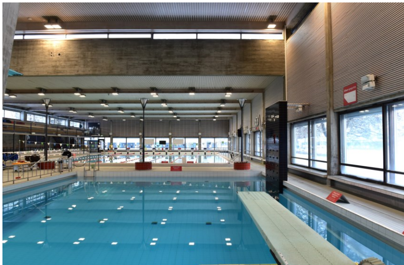
Kuva: Allashalli nykyasussaan. Puhdasvaluisten betonipintojen alat ovat pienentyneet. Suurin tilaan vaikuttanut muutos on ollut alakaton rakentaminen. Valaisimet on vaihdettu spotteihin. Hyppyaltaalle on tehty kiipeilyseinä.
