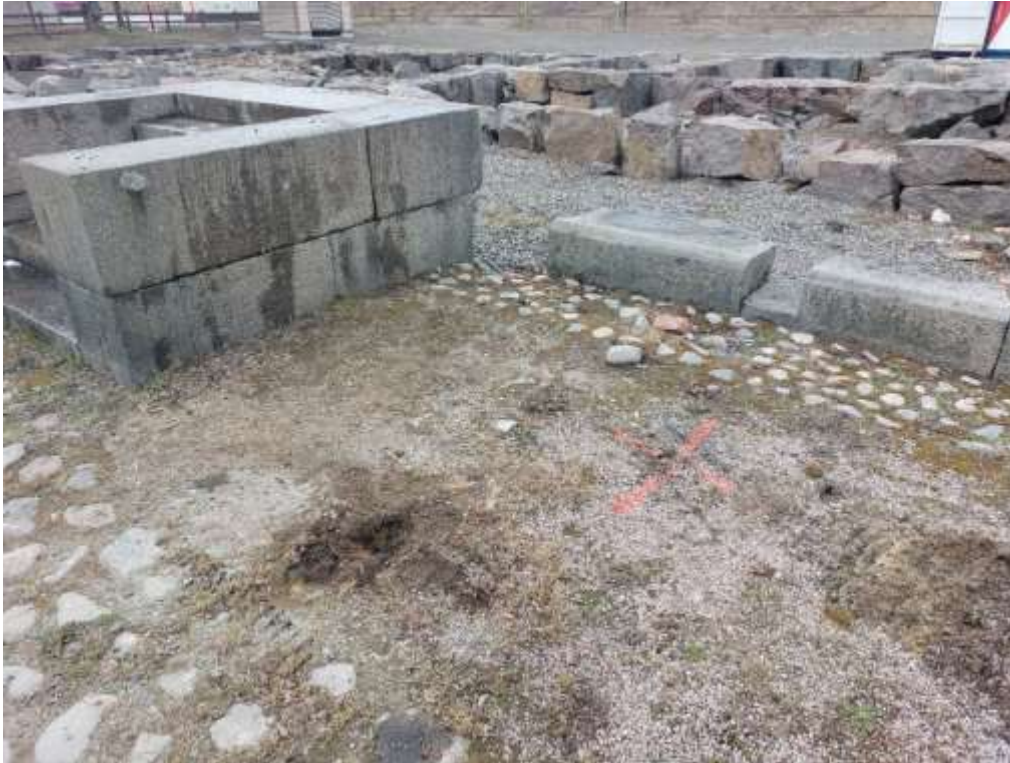
Kuva 5. Kairapiste P2. Kairaus pysähtyi kiveen noin 1 metrin kohdalla.
