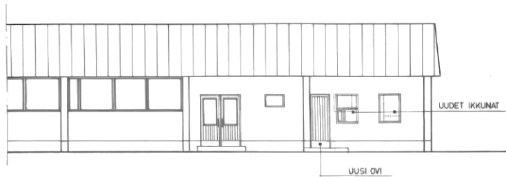
Kuva 54. Vuonna 1977 toripöytävaraston tiloihin suunniteltu torivalvojan ja -myyjien sosiaaliilat. Julkisivuun on lisätty uusi ulko-ovi ja kaksi ikkunaa uusittu. Torivalvojan koppi on poistettu. Lähde: LKA
